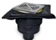
KRASO® Hof-/Parkdeckablauf Typ 1,5 mit Edelstahlrost mit Folienflansch
