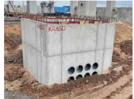
KRASO® Pumpensumpf - Beton - Sonder Innenmaße ca. 160 x 160 x 1,95 cm, 8 KRASO® Futterrohre Typ FE ID 200, aus WU-Beton, mit 20 cm starken, Stahlfaserbewehrten Wand- und Bodenplatten ( 20 Kg/ per cbm ). Anschlussbewehrung ca. 8/15 doppelreihig, umlaufendes, druckwasserdichtes, MPA-geprüftes, Arbeitsfugenband KRASOflex® Duo-Fix 150 „plus“, 4 Transportanker Rd30, Gesamtgewicht: ca. 8,80 t
