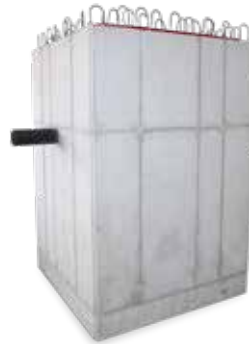
KRASO® Pumpensumpf - Beton - Sonder Innenmaße ca. 104 x 104 x 192 cm, aus WU-Beton, mit 20 cm starker, stahlfaserbewehrter Wand- und Bodenplatte (20 kg/ per cbm). Anschlussbewehrung ca. 8/15 doppelreihig, umlaufendes, druckwasserdichtes, MPA-geprüftes, Arbeitsfugenband KRASOflex® Duo-Fix 150 „plus“, einschließlich PE Rohr DN 124 mit umlaufender, druckwasserdichter KRASO® Vierstegdichtung mit beidseitigem Überstand von ca. 15 cm, 4 Transportanker Rd20, Gesamtgewicht: ca. 5,94 t
