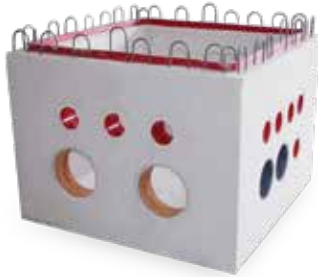
KRASO® Pumpensumpf - Beton - Sonder Innenmaße ca. 100 x 270 x 150 cm, aus WU-Beton, mit 12 cm starken, stahlfaserbewehrten Wänden aus einem Guss. Anschlussbewehrung ca. 8/15 doppelreihig, umlaufendes, druckwasserdichtes, MPA-geprüftes, Arbeitsfugenband KRASOflex® Duo-Fix 150 „plus“, 4 Transportanker M20, Anschlüsse: 8 x DN 110, 2 x DN 250, 2 x ID/FE 200, Gesamtgewicht: ca. 1,5 t
